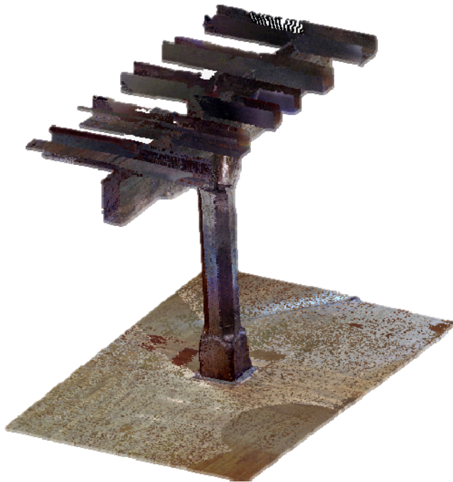
Punktwolke einer Stütze Selektierung einzelner Bereiche
