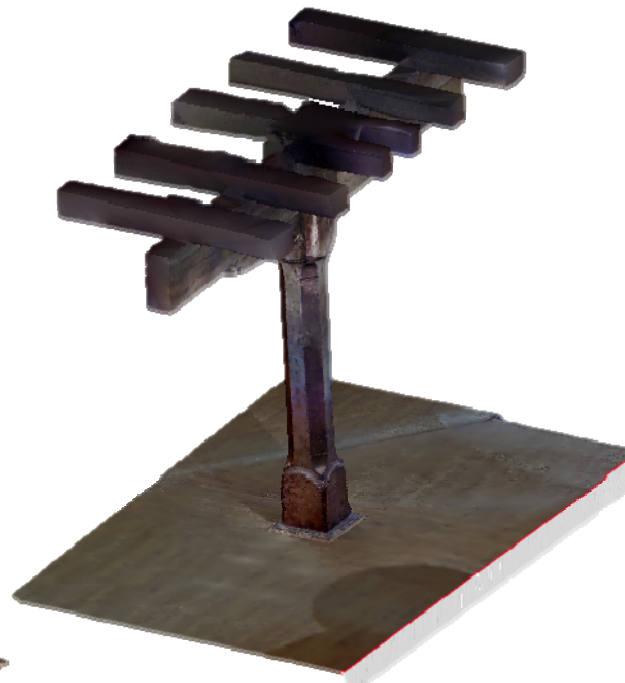
Volumenmodell aus der Punktwolke
